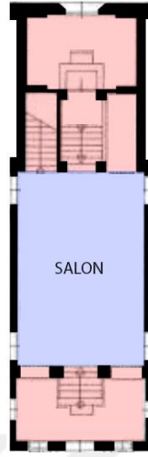
Şekil 5.79 Yükseltilmiş Zemin Kat Rekonstrüksiyon Planı (Breckner, 1988'den akt. Thun-Hohenstein, 2012, 152'den renklendirilmiş çizim: Merve Köse)
