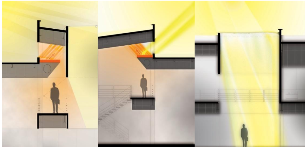
Şekil; IV,3: Farklı çatı ışıklıklarının mekândaki etkileri. 102
