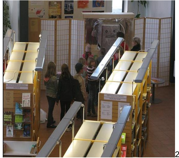
Resim. IV,9: Koridor merkezine hizalanmış ve kitap rafı ile birleşik paralel aydınlatma sistemi (Resim1:Yuma Main Library, Uyah, A.B.D) 115 ( Resim 2: Kirjasto Libraries, Finlandiya ) 116
