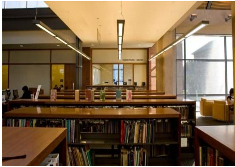
Resim. IV,10: Kitap raflarına dik aydınlatma sistemi (Alameda free library, San Francisco, A.B.D. 117 )
