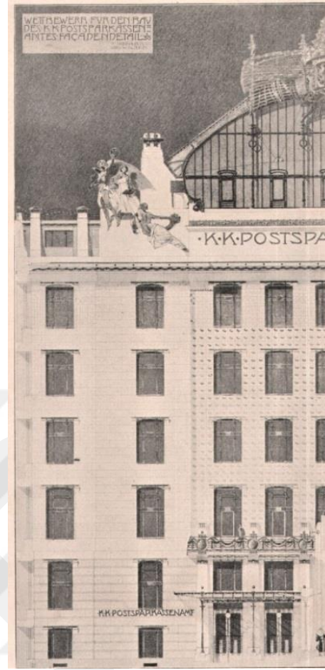
Şekil 5. Doğu Cephesi Ayrıntı Çizimi, Wagner, 1903 (I. Evre) (Der Architekt, "Der Wettbewerb um den Bau des Postsparkasseamtes in Wien" ek 78)
