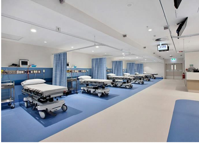
Görsel 10. PVC (Polivinil klorür) Zemin Kaplama Hastane İç Mekân Örneği (URL 11)
